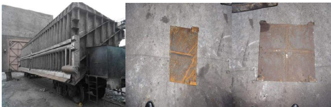
Рисунок 1 – Плита коксогасильного вагону зміцнена в умовах СВС а) загальний вигляд вагону, б) плита без покриття (після застосування); в) плита з легованим титаном АП (після застосування)
