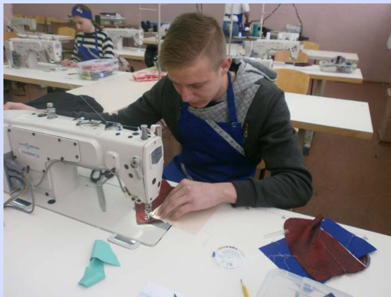
Універсальна машина для середніх тканин укомплектована сервомотором S-F01/8700D
